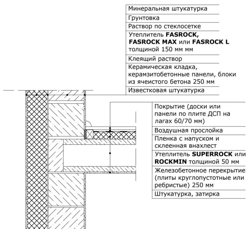
Рисунок.37. Узел примыкания стены перекрытия 1-го этажа, на отметке +0.000 мм.
